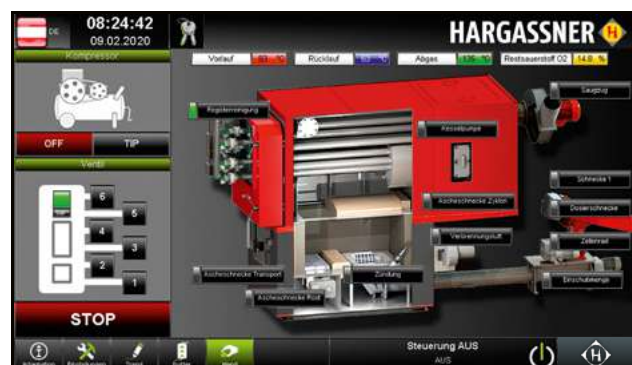
Funktions- & Relais-test für alle Sensoren und Motoren
