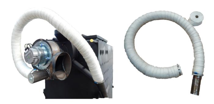
☐ Den Schlauch mit hitzebeständigem Isolierband isolieren
