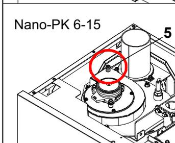
Ausführung als Thermoelement (Typ K) mit angeschlossener Fühlerleitung.
