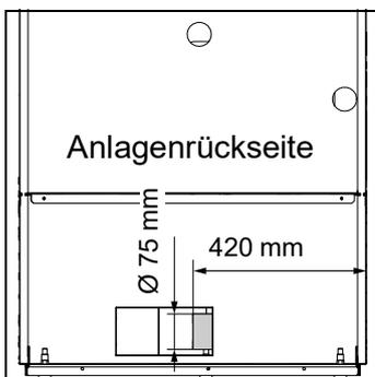
Vorzugsweise ist für die Luftzufuhr ein LAS (Luft-Abgassystem) zu verwenden, da die Mündungen dieses LAS entweder konzentrisch oder so nahe beieinander liegen, dass für sie ähnliche Windbedingungen zutreffen.
