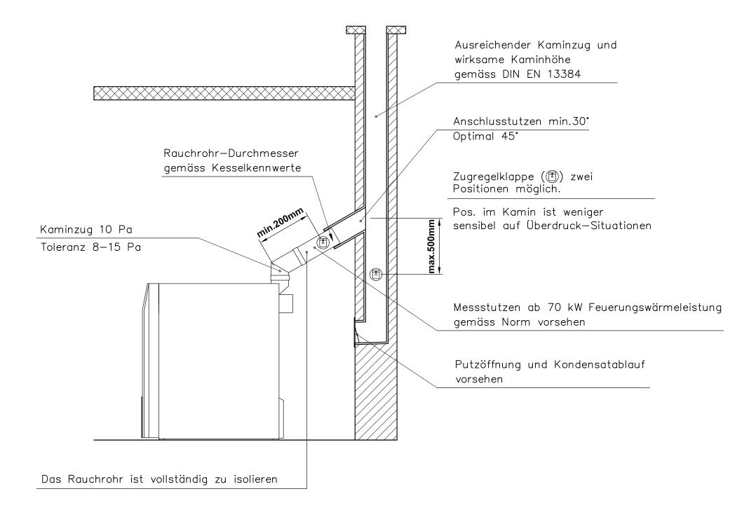
Der Kaminbauer oder Planer ist für die richtige Dimensionierung verantwortlich. Ist der Kaminzug nicht gemäss Kesselkennwerte gegeben, kann die Nennleistung und die Emissionswerte vom Kessel nicht eingehalten werden.
