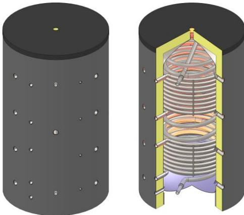
Frischwasserspeicher mit 2 Wärmetauscher
