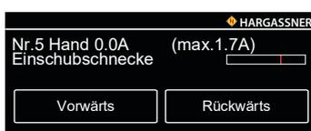
Nr. 5 Funktions- und Drehrichtungsprüfung des Einschubschneckenmotors
