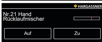
Nr. 21 Funktions- und Drehrichtungsprüfung des Rücklaufmischers
