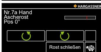
Nr. 7a Funktions- und Drehrichtungsprüfung des Ascherostmotors
