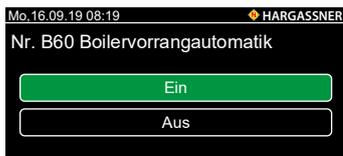
Nr. B60 Boilervorrangautomatik zum raschen Laden der Boiler
