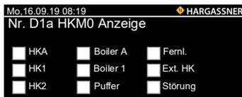
Nr. D1a Auswahl der Anzeigemöglichkeit bei angeschlossenem HKM 0
