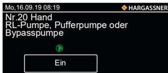
Nr. 20 Funktionsprüfung bzw. manueller Betrieb der parametrieren Pumpe
