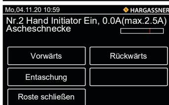
Nr. 2 Funktions- und Drehrichtungsprüfung des Ascheaustragungsmotors
