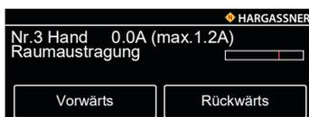
Nr. 3 Funktions- und Drehrichtungsprüfung des Raumaustragungsmotors
