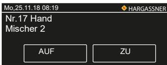
Nr. 17 Funktions- und Drehrichtungsprüfung des Mischers HK2.
