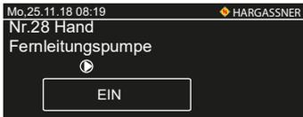
Nr. 28 Funktionsprüfung bzw. kurzfristiger manueller Betrieb der Fernleitungspumpe.
