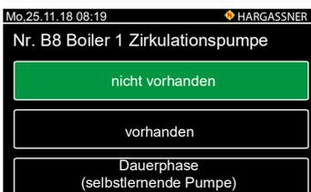
Nr. B8 Einstellen der Zirkulationspumpe kann für jeden in der Steuerung parametrisierten Boiler erfolgen.
