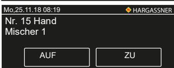
Nr. 15 Funktions- und Drehrichtungsprüfung des Mischers HK1.
