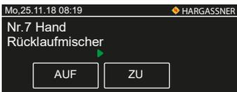
Nr. 7 Funktions- und Drehrichtungsprüfung des Rücklaufmischers
