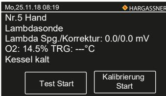
Nr. 5 Lambdasonde bei der Erstinbetriebnahme **testen** (Dauer ca. 5 Minuten)
