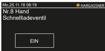
Nr. 8 Funktions- und Drehrichtungsprüfung des Schnellladeventils
