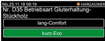
Nr. D35 Die Steuerung erkennt anhand der Zusammensetzung des Rauchgases, dass das Brennmaterial in der Anlage zu Ende geht und wechselt je nach Einstellung in den Zustand **Ausbrand** oder **Gluterhaltung**.
