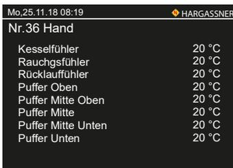
Nr. 36 Funktionskontrolle der einzelnen Fühler
