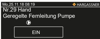
Nr. 29 Funktionsprüfung bzw. manueller Betrieb der geregelten Fernleitungspumpe.
