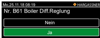
Nr. B61 Freigabe der Boilerpumpe (Boilerladung) bei Kesselzustand **Aus**, wenn
