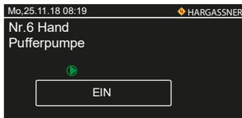
Nr. 6 Funktionsprüfung bzw. kurzfristiger manueller Betrieb der Pufferladepumpe
