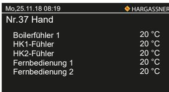
Nr. 37 Funktionskontrolle der einzelnen Fühler
