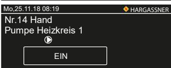
Nr. 14 Funktionsprüfung bzw. kurzfristiger manueller Betrieb der
