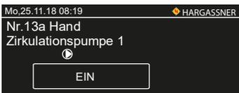
Nr. 13a Funktionsprüfung bzw. kurzfristiger manueller Betrieb der Zirkulati-
