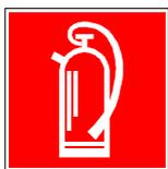
Geprüften (alle 2 Jahre) Feuerlöscher leicht zugänglich außerhalb des Heizraumes neben der Heizraumtür montieren:
