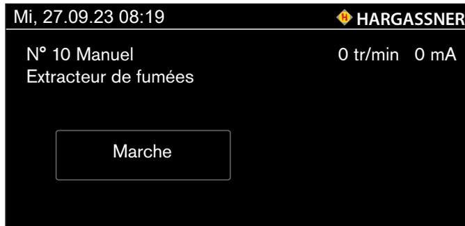
N° 10 Contrôle du fonctionnement du moteur d'extraction des fumées
