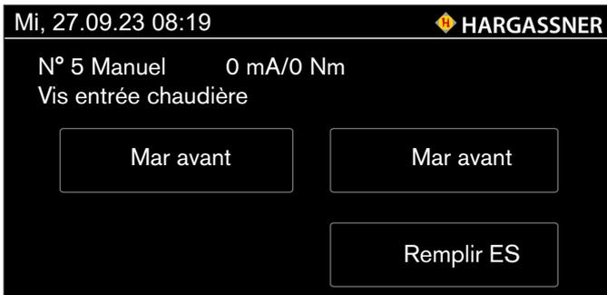
N° 5 Contrôle du fonctionnement et du sens de rotation du moteur de la vis d'entrée chaudière
