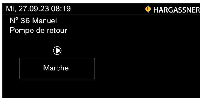
N° 36 Contrôle du fonctionnement ou fonctionnement manuel de la pompe paramétrée
