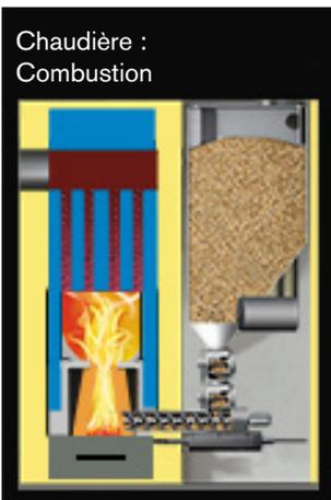
La commande règle l'extracteur de fumées (volume d'air) selon la puissance demandée et la température chaudière nécessaire et, grâce au signal de la sonde Lambda, la quantité de combustible optimale.
