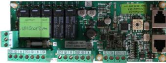
Le Module de Zone permet d'ajouter 1 Zone et 1 Ballon sur la chaudière. Le raccordement sur la platine de la chaudière se fait avec un câble BUS.
