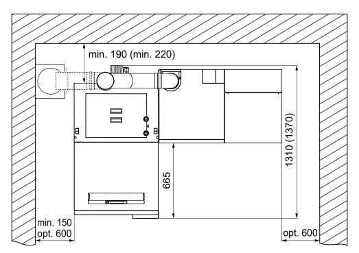
Kit de raccordement du conduit de fumée pour Neo-HV 20-60 et Smart-PK 17-32
