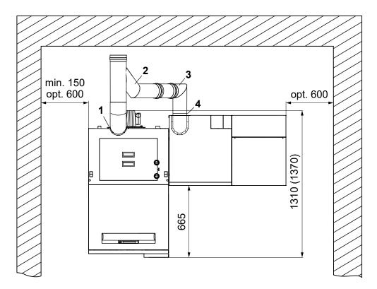
Kit de raccordement du conduit de fumée pour Neo-HV 20-60 et Smart-PK 17-32
