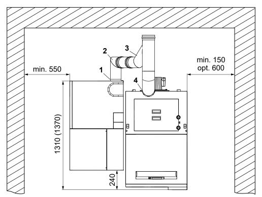
Kit de raccordement du conduit de fumée pour Neo-HV 20-60 et Smart-PK 17-32
