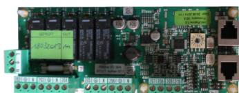
La carte de zone sert à l'extension des circuits de chauffage et de ballon sur la chaudière. Le raccordement sur la carte de la chaudière a lieu via un câble bus.
