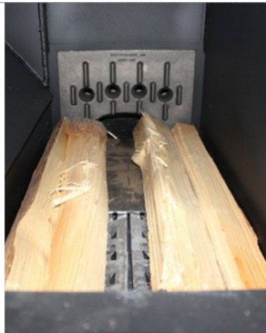
a.) Tunnel d'allumage
