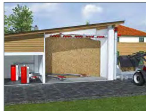
Remplissage par vis verticale puis vis horizontale en cas de traversée d'une pièce ou d'un local rectangulaire allongé
