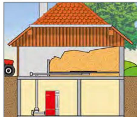
Silo au 1<sup>er</sup> étage avec remplissage direct et alimentation de la chaudière par tube de chute au sous-sol.
