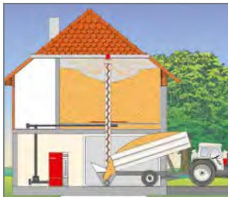
Grand silo au 1<sup>er</sup> étage avec remplissage par vis verticale et alimentation de la chaudière par tube de chute au RdC.
