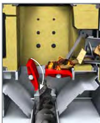
Avec un combustible comme le bois, un **déchargement partiel** suffit : seule la grille de déchargement s'ouvre. La cendre tombe dans la vis de déchargement tandis que la braise reste intacte.
