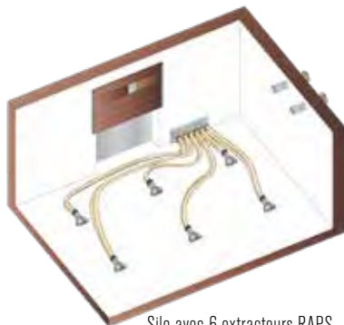
Silo avec 6 extracteurs RAPS et commutation automatique
