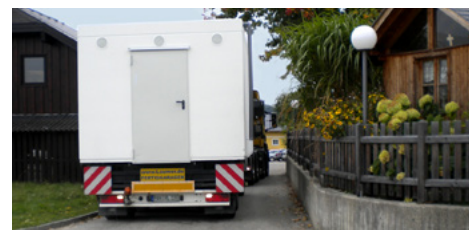
Lieferung der Heizmodule mit Tiefloader
