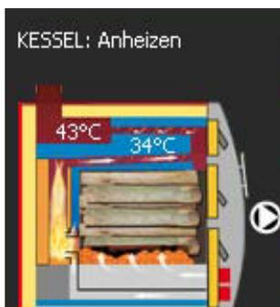
☞ Sollte die Abgastemperatur nicht schnell ansteigen, weil zu feuchtes oder grobes Brennmaterial verwendet wurden ist, kann die Aschetür für ein paar Minuten geöffnet werden.
