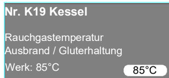
Ist die Rauchgastemperatur länger als <Nr. K17 Kessel> (15 min.) unter <Nr. K19 Kessel> (90°C) schaltet die Steuerung in den Zustand <Gluterhaltung>
